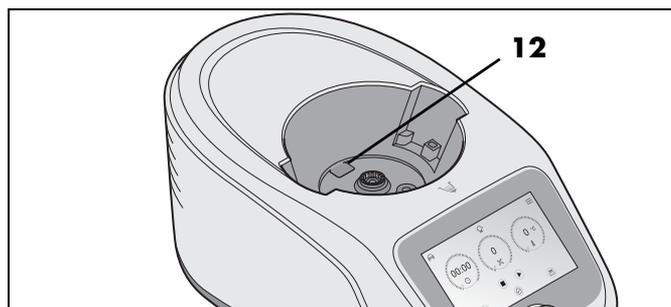
Le liquide sortant éventuellement du bol mixeur **5** ne s'accumule pas dans l'appareil de base **13** mais peut s'écouler sur le plan de travail en passant par le trop-plein **12**.
