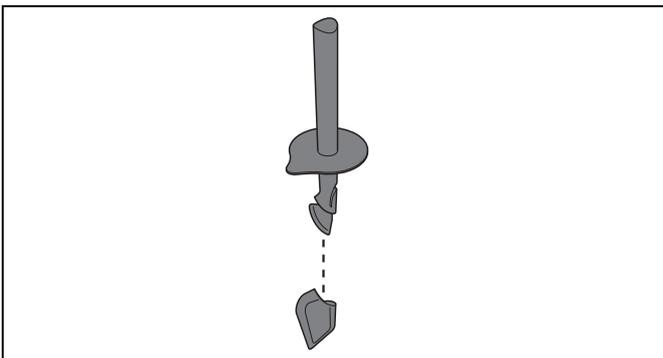
Enlevez le racleur en silicone pour le nettoyer et vérifiez s'il est en bon état. Vérifiez s'il est détérioré (par ex. matériau poreux ou fissures).
