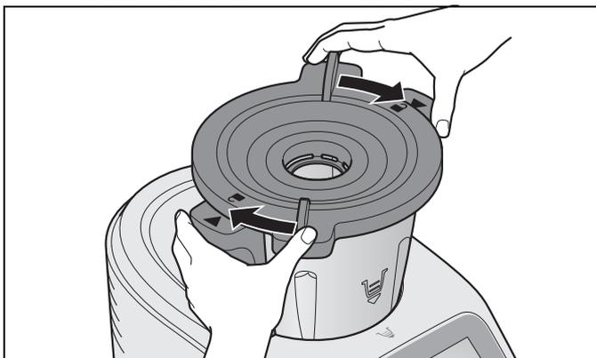
2. Appuyez sur le couvercle **23** et tournez-le à deux mains dans le sens horaire. L'appareil ne peut être mis en marche qu'une fois que le couvercle **23** est parfaitement fermé. Un signal audio indique que l'appareil est prêt à fonctionner.
